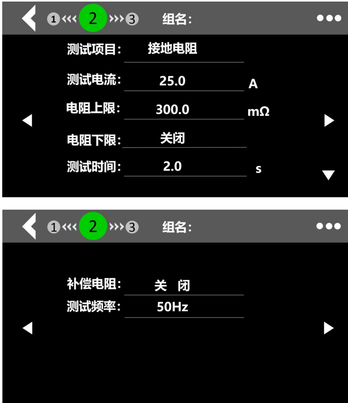
图 5-5-2 接地电阻设置界面
