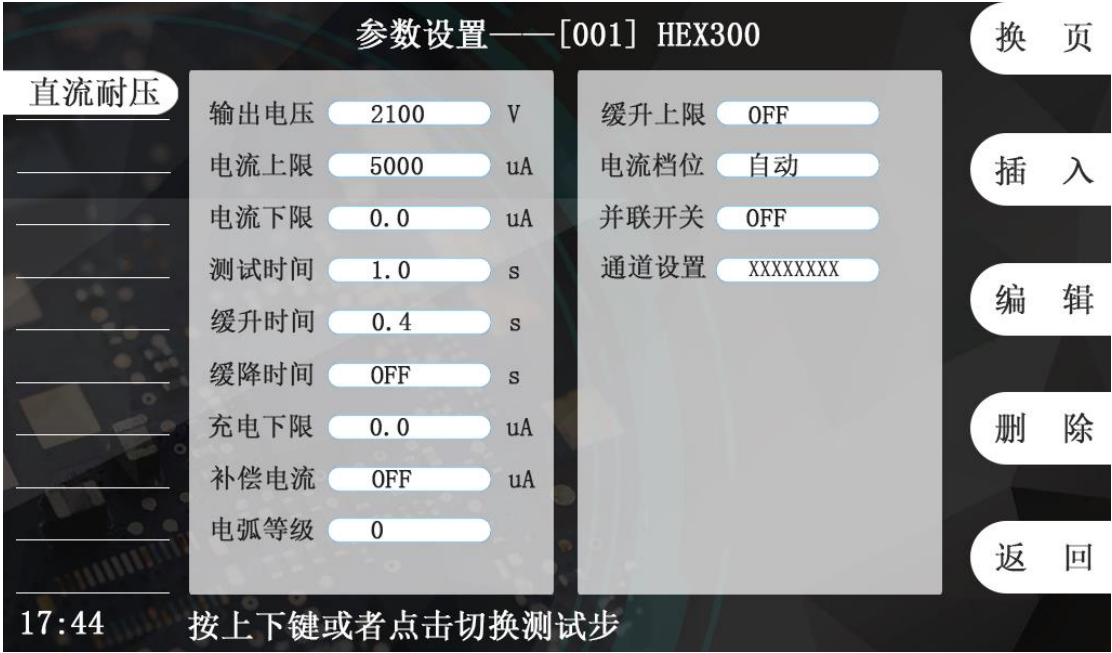
图 5-5-3 直流耐压设置界面
