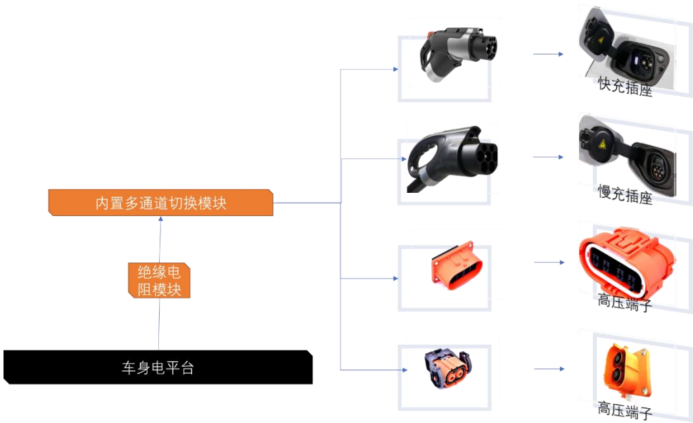
图 5-1-2 绝缘测试接线示意图
