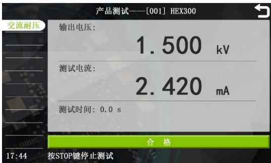
图 5-3-4 测试完成后显示单步结果
