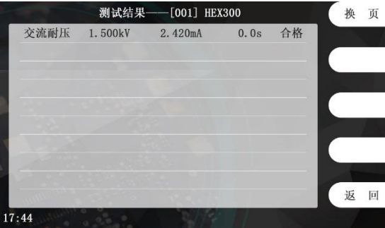
图 5-3-5 测试完成后以列表形式显示测试结果
