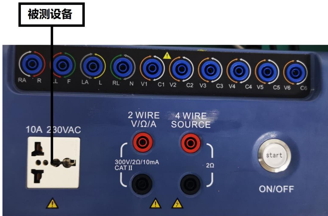
图 40 电源对保护接地接线图
