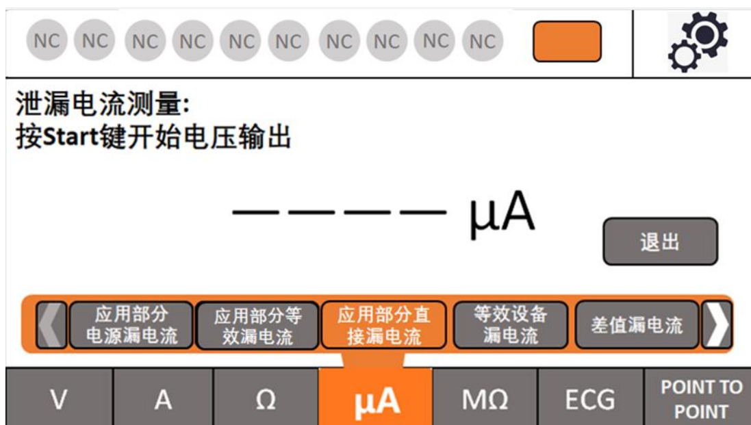
图 30 应用部分直接漏电流测试页
