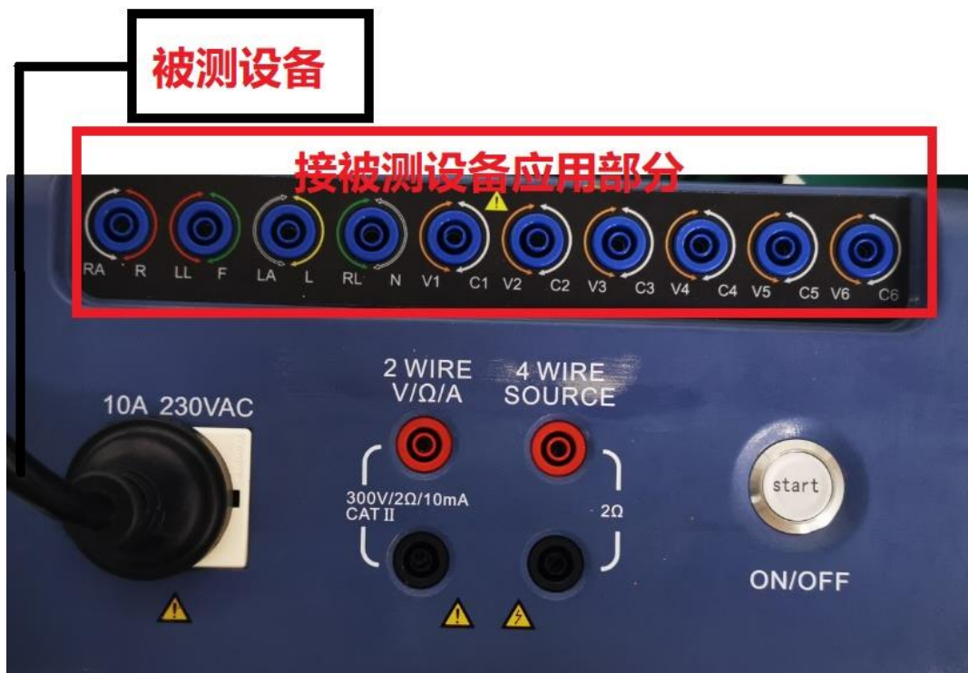
图 10 对地漏电流接线
