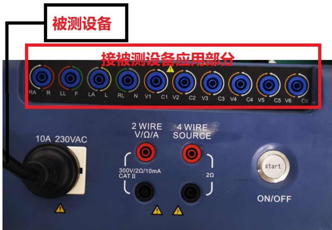
图 16 患者漏电流接线图
