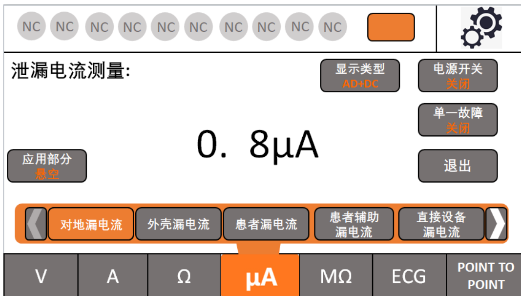
图 9 对地漏电流测试页
