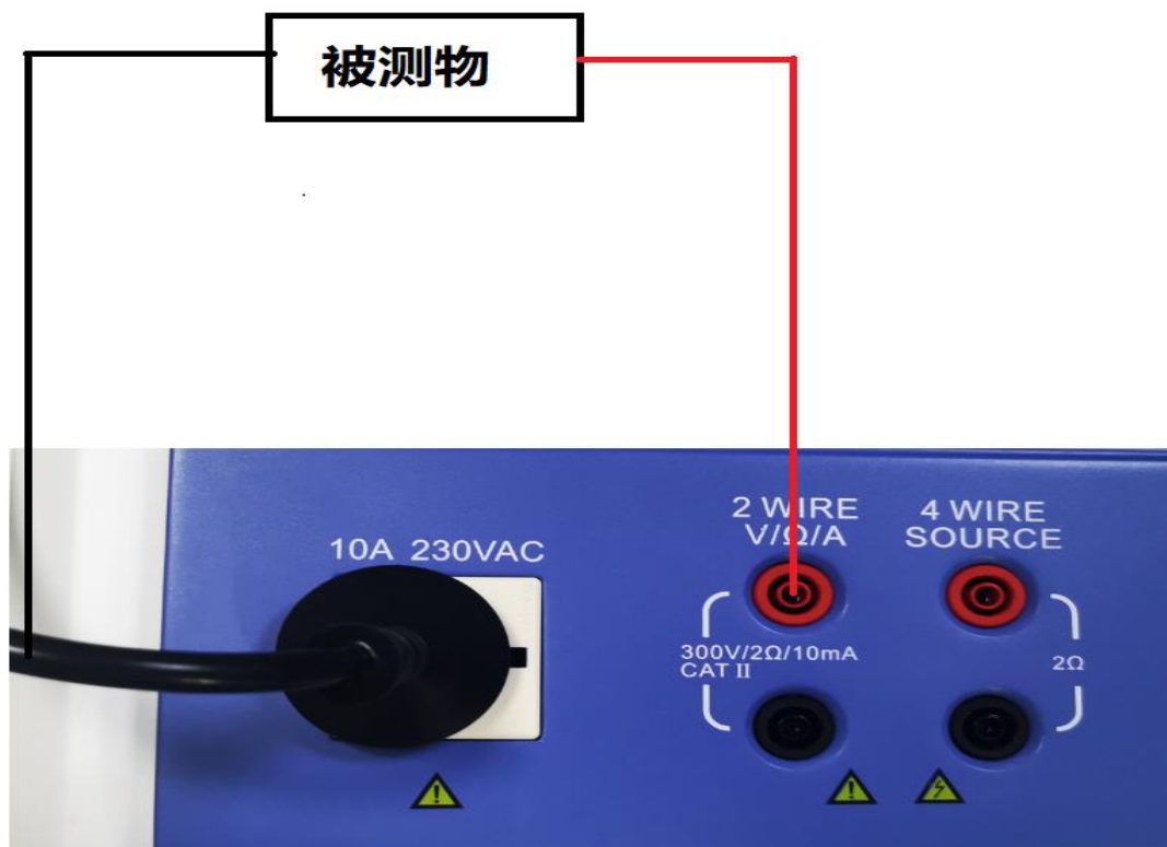
图6 接地电阻两线法连接
