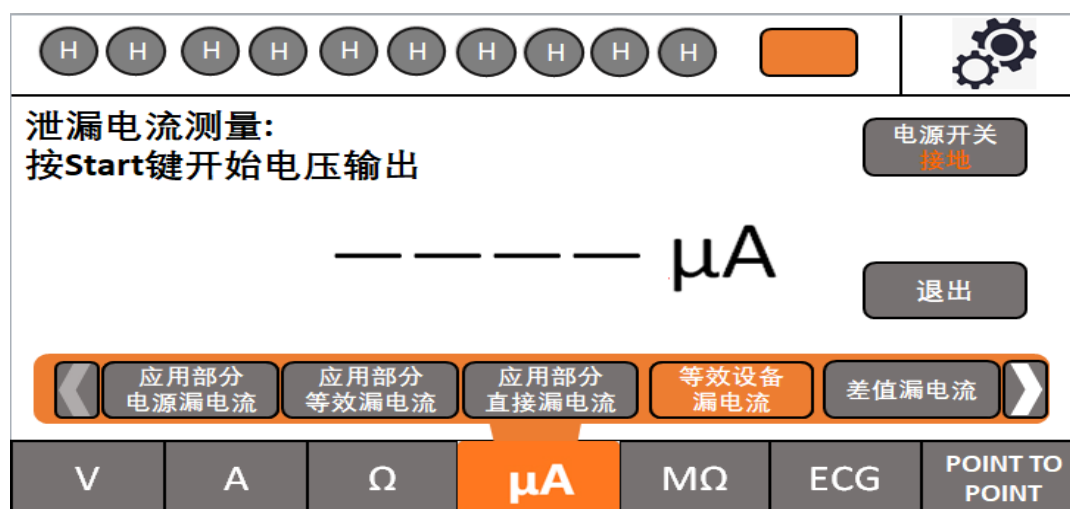
图 33 等效设备漏电流测试页
