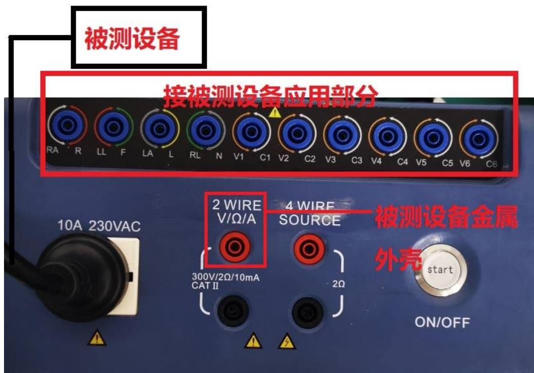
图 28 应用部分等效漏电流接线图
