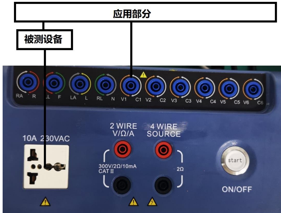
图 42 应用部分对保护接地接线图
