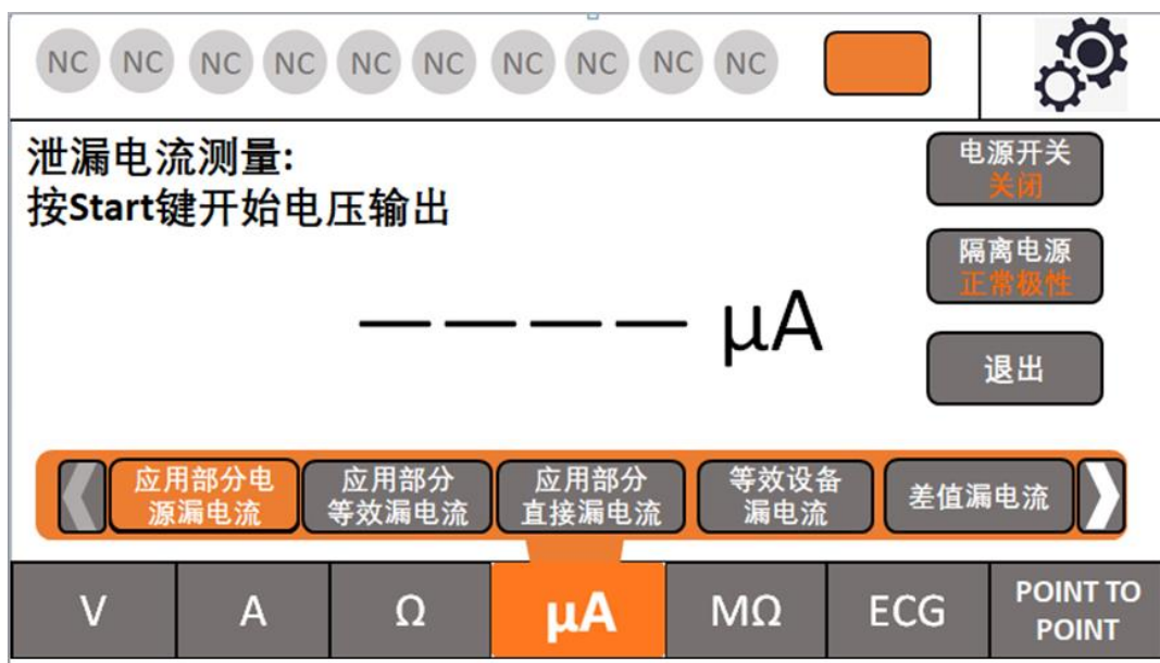
图 24 应用部分上的电源漏电流测试页
