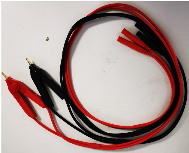
图 57 四线电阻测试线
