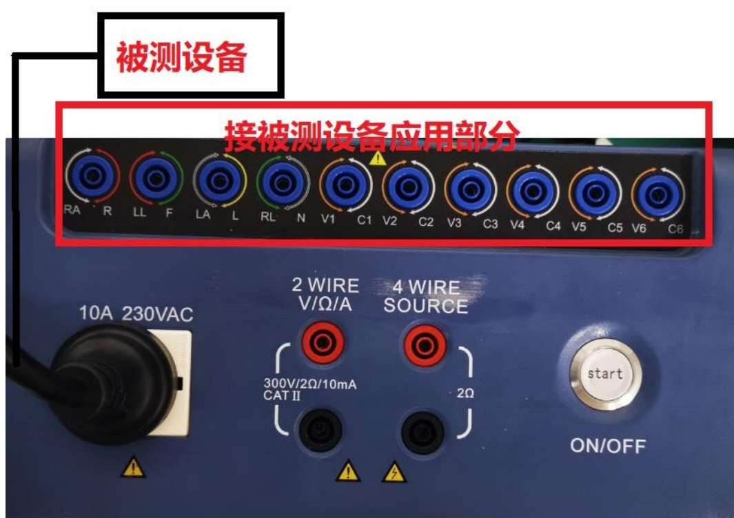
图 37 差值漏电流接线图
