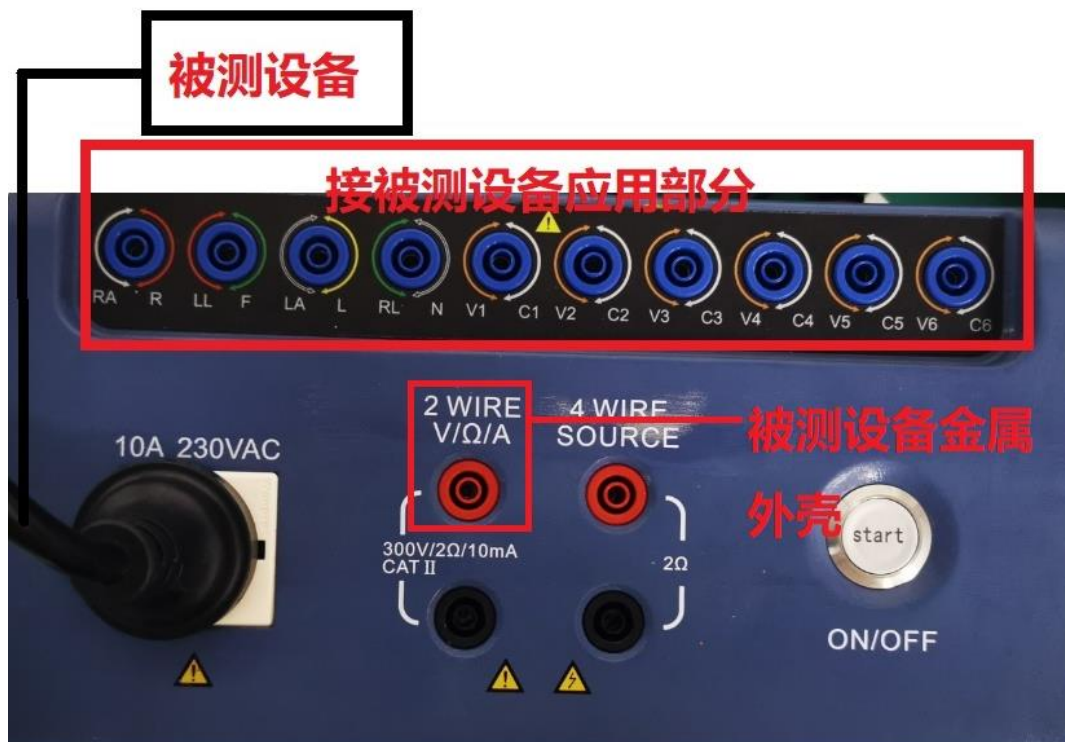
图 22 直接设备漏电流接线图
