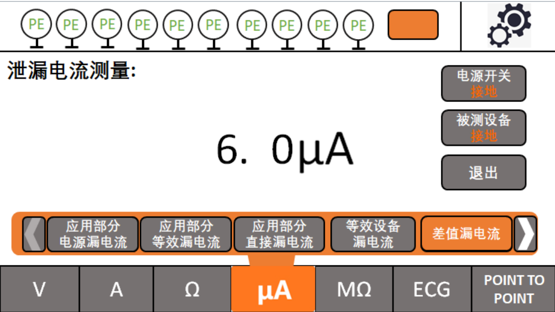
图 36 差值漏电流测试页
