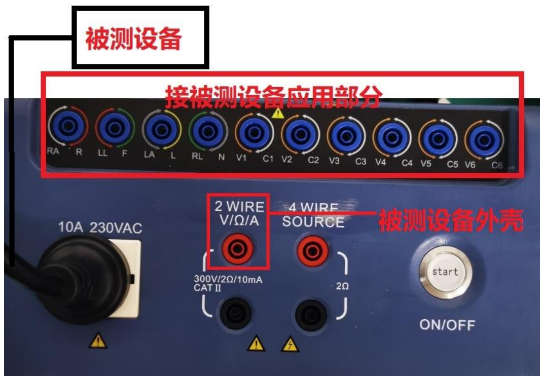
图 13 外壳漏电流接线
