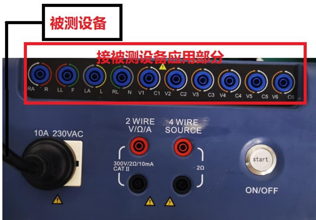
图 19 患者辅助漏电流接线图
