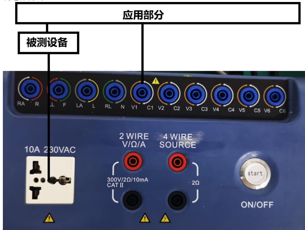
图 44 电源对应用部分接线图
