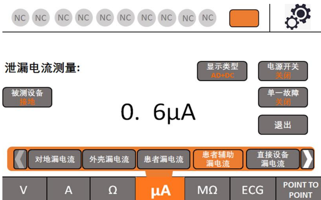
图 18 患者辅助漏电流测试页
