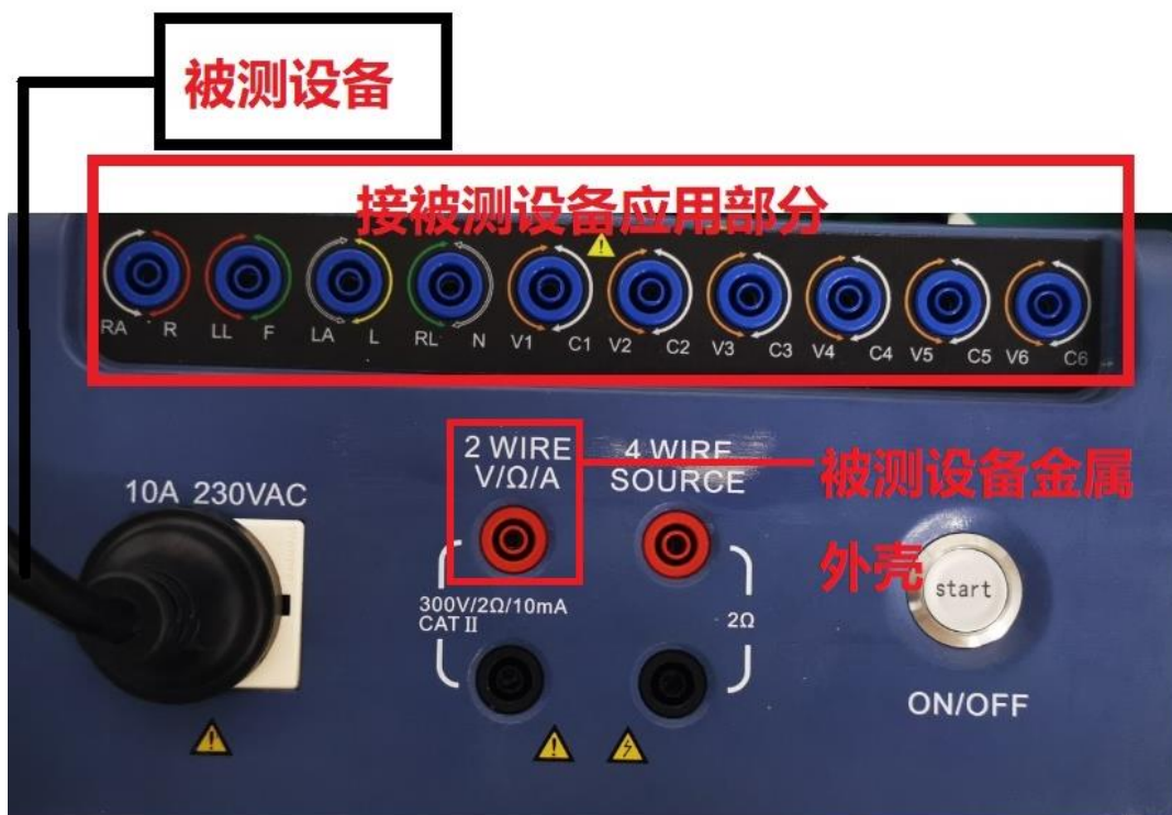
图 25 应用部分上的电源漏电流接线图
