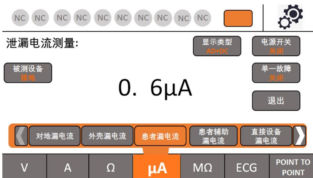
图 15 患者漏电流示意图
