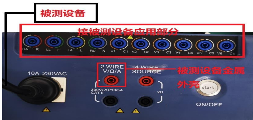
图 34 等效设备漏电流接线图
