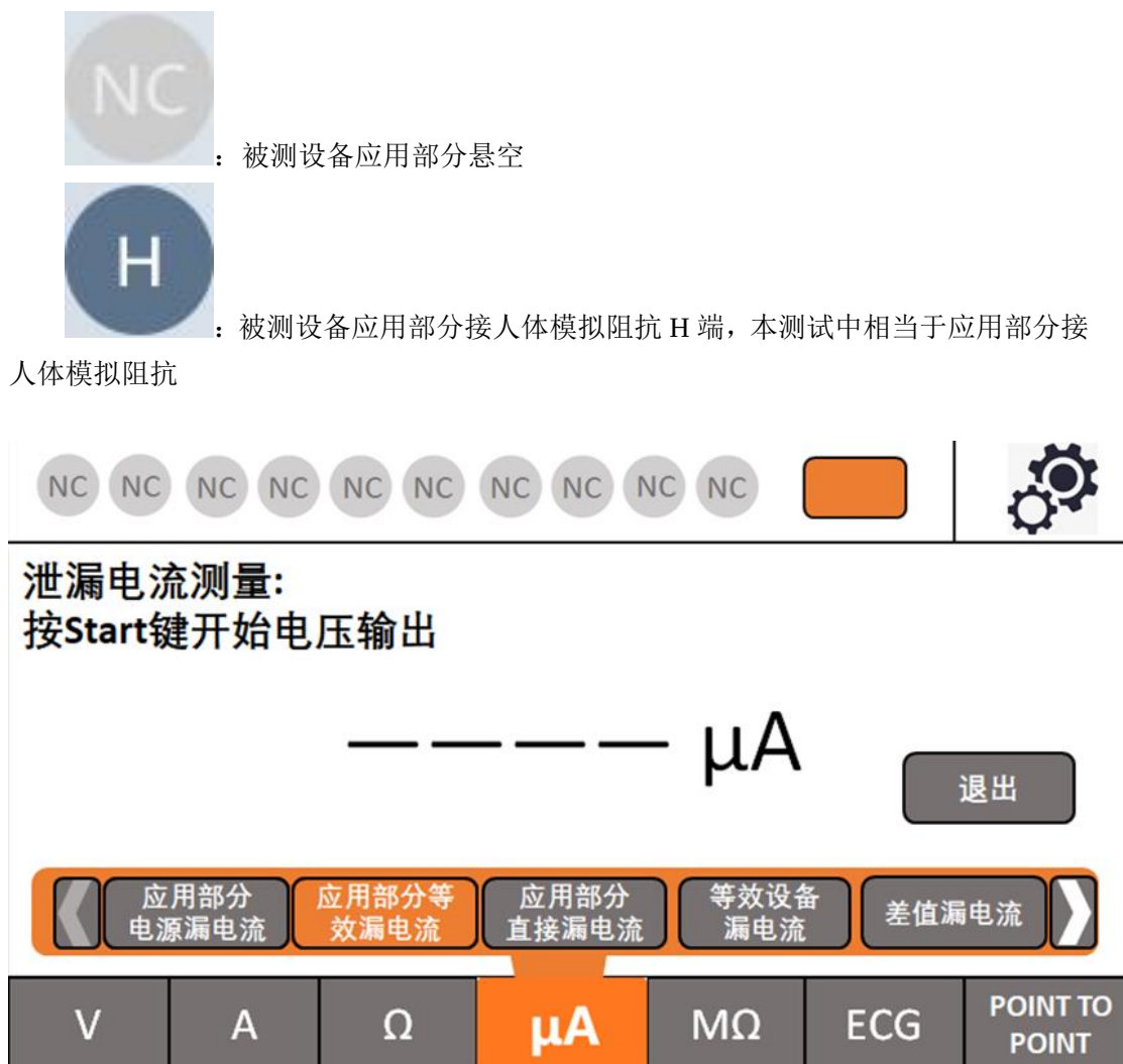
图 27 应用部分等效漏电流测试页
