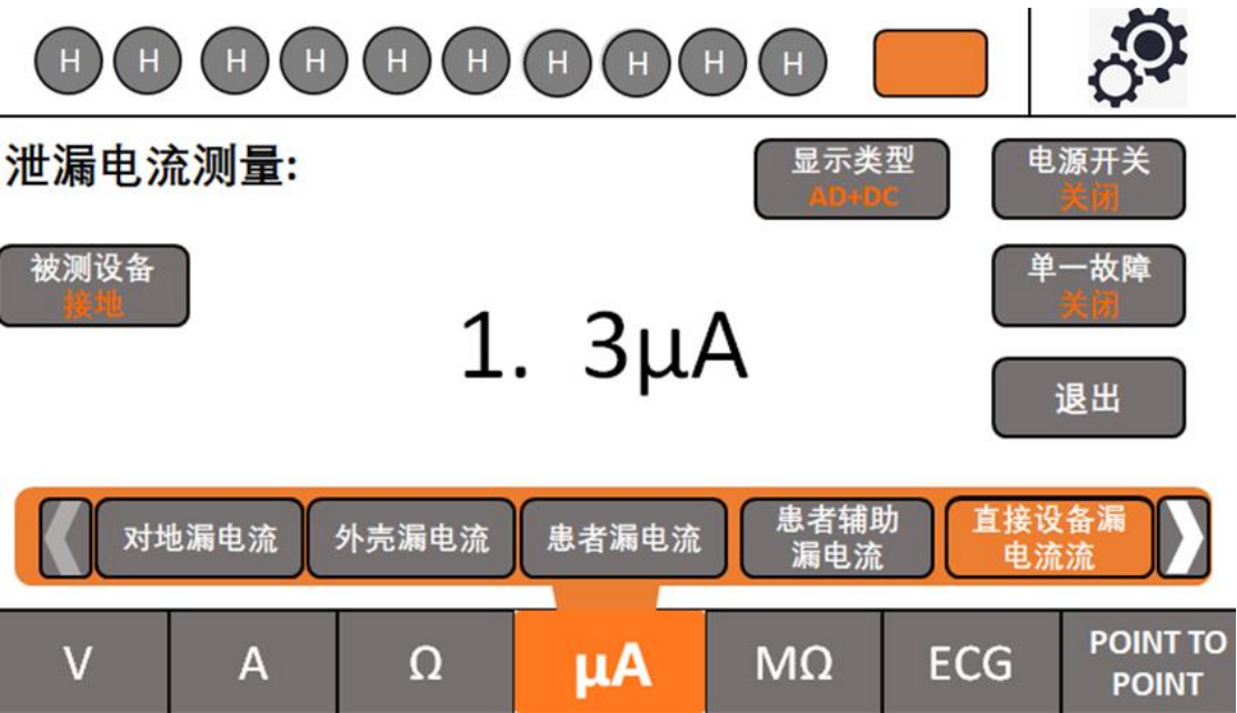
图 21 直接设备漏电流测试页
