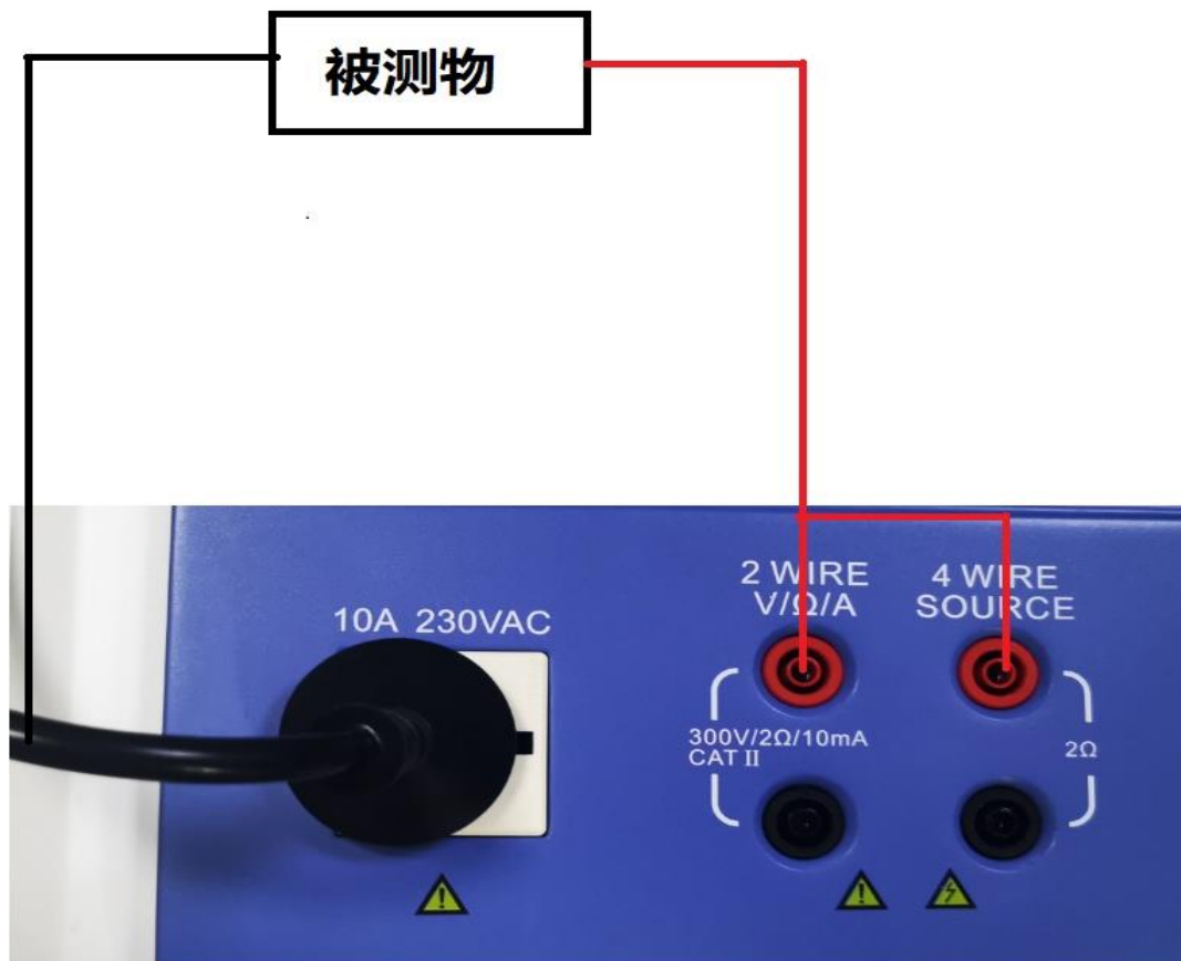
图7 接地电阻测试四线法
