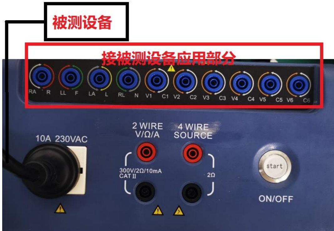
图 31 应用部分直接漏电流接线图
