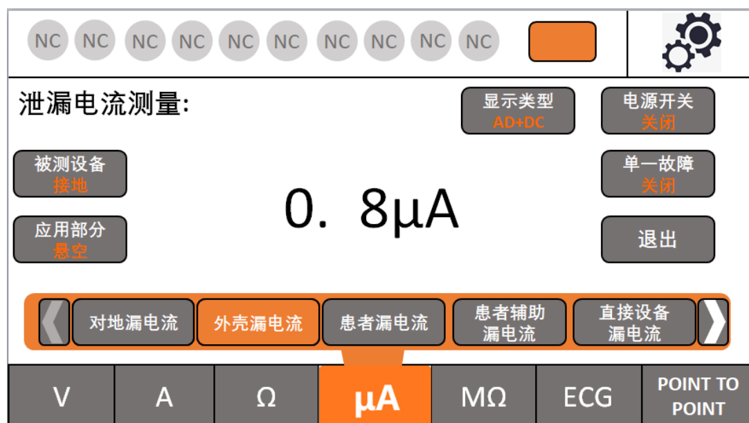
图 12 外壳漏电流测试页
